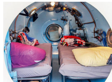
Eines der beiden «Schlafzimmer» der Sättigungstaucher. Es ist an die anderen Module der Druckkammer angedockt.
