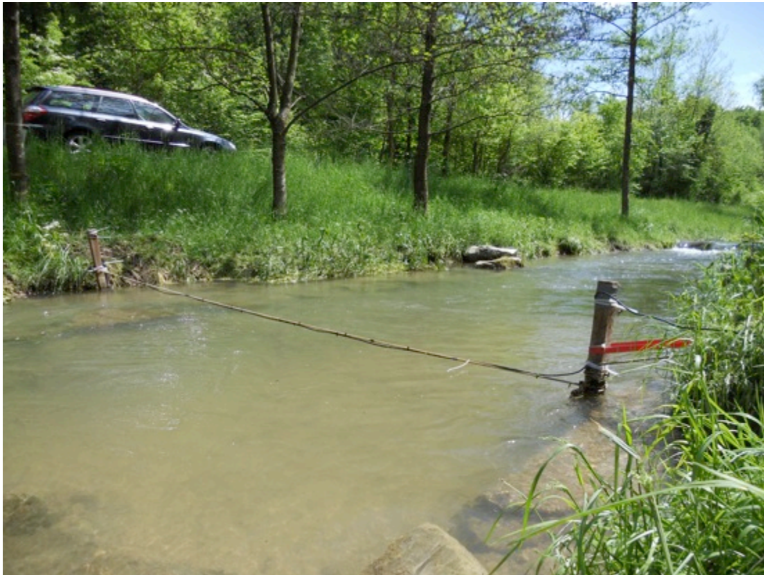
Die Antenne überspannt den Möhlinbach. In der Bachsohle wird die Antenne zurückgeführt, so dass sie ein elektromagnetisches Feld erzeugt. Fische, die hier durchschwimmen und einen PIT Tag eingepflanzt haben, werden registriert.
